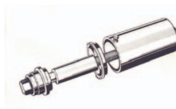
Werkzeug zum Austausch von Buchsen an Federaggregaten
