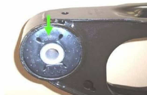
Bild 2: Einbauposition „TOP“ Markierung beachten
