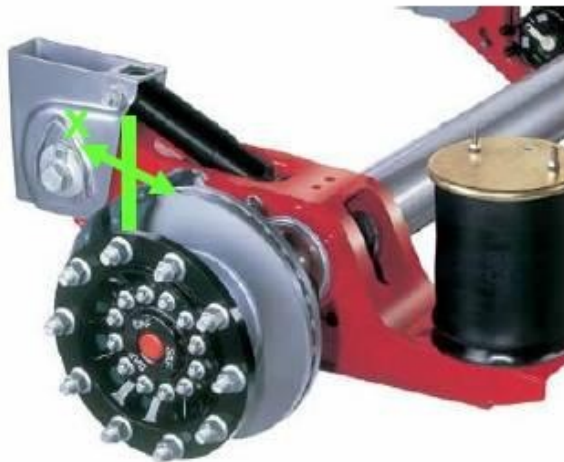
Bild 1: Gelenkelastizität horizontal: x = \pm 14 mm, gesamt 28 mm
