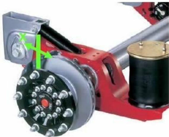
Bild 1: Gelenkelastizität horizontal: x = \pm 14\text{mm} , gesamt 28 mm
