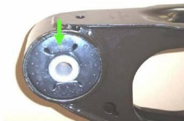
Bild 2: Einbauposition „TOP“ Markierung beachten
