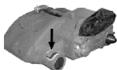
Gráfico 1: La placa de datos técnicos se encuentra siempre en el elemento inmovilizador.
