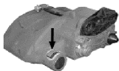
Bild1: Das Typenschild befindet sich immer am Festlager
