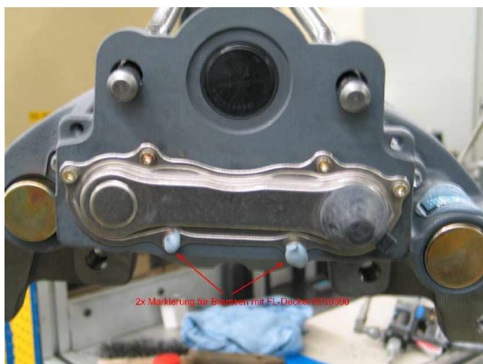
Rys. 3: Dwa jasnoszare oznaczenia na hamulcach IO
