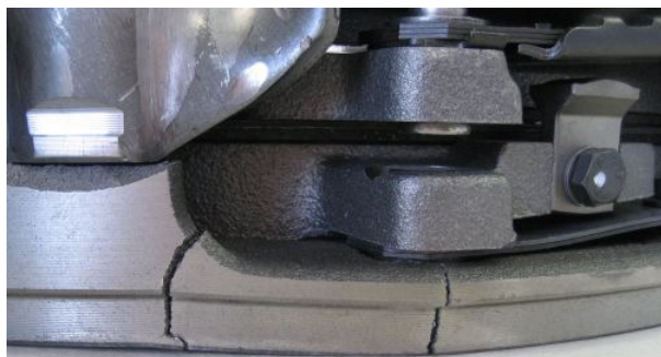
Рис. 4: Поломка промежуточного кольца
