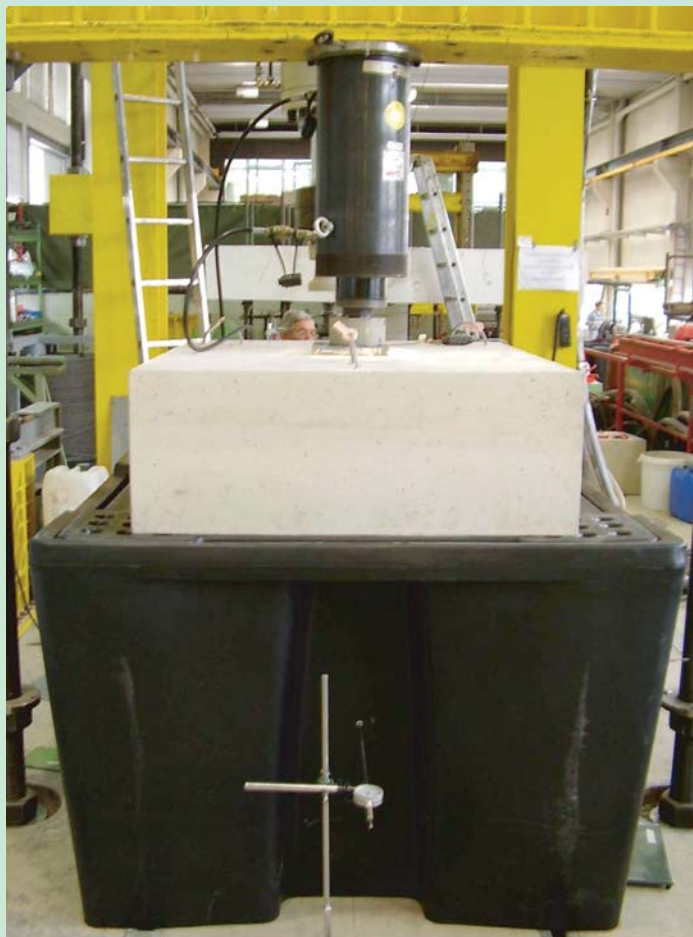
IBC-Einfachstation SJ-500-002/D unter Prüflast (8000 kg)
