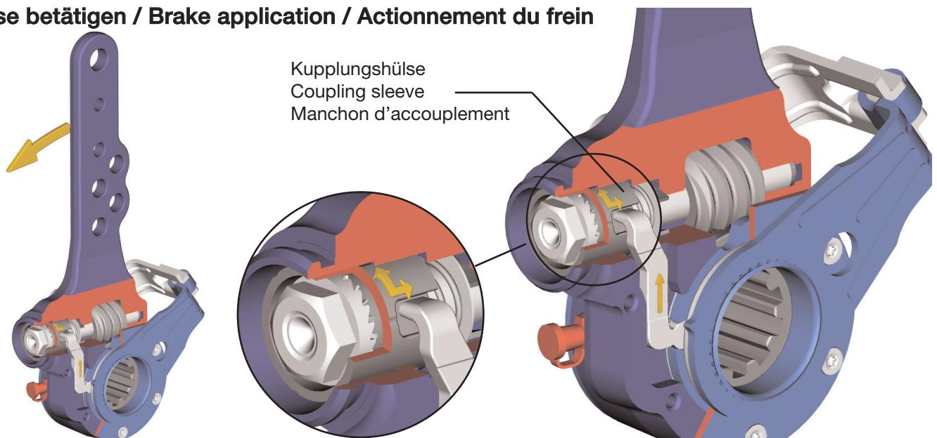
Bei zunehmenden Zylinderhub wird die Kupplungshülse vom Nachstellhebel gedreht. Der Nachstellpunkt wird nicht erreicht, die Zähne rasten nicht über. Der Hub bis zum Nachstellpunkt ist durch die Nutbreite und die Zahnlänge der Kupplung vorgegeben. Bremshübe, die innerhalb dieses Bereiches liegen, stellt der Automatische Gestängesteller nicht nach.
