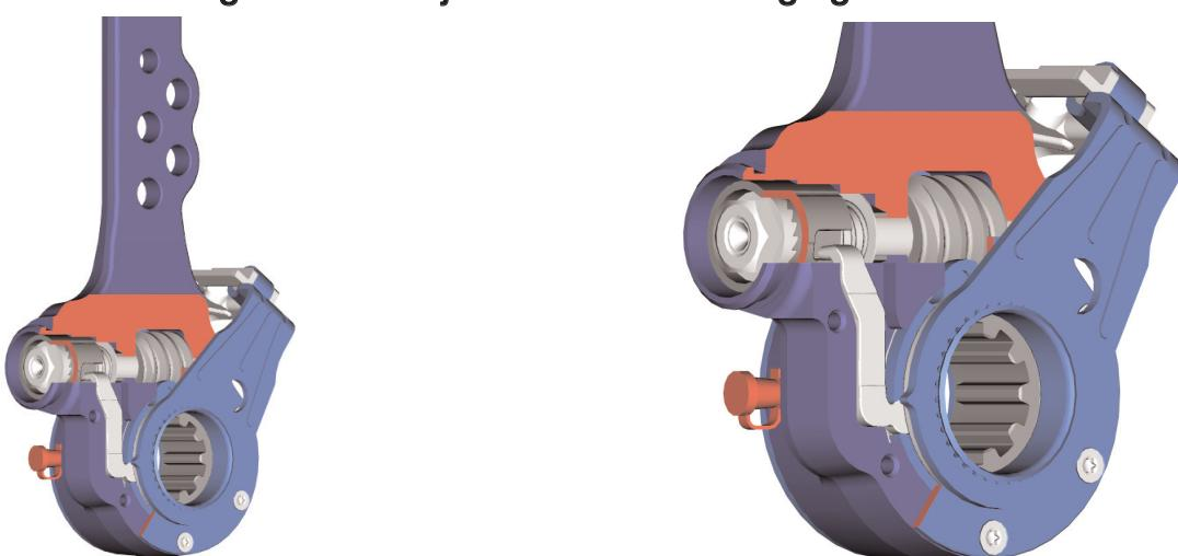
Nach Beendigung der Nachstellung ist die Ausgangsstellung erreicht. Da die Zahnkupplung nur wegabhängig in kleinen Schritten formschlüssig nachstellt und nicht stufenlos kraftschlüssig, erfolgt immer eine exakte Nachstellung.
