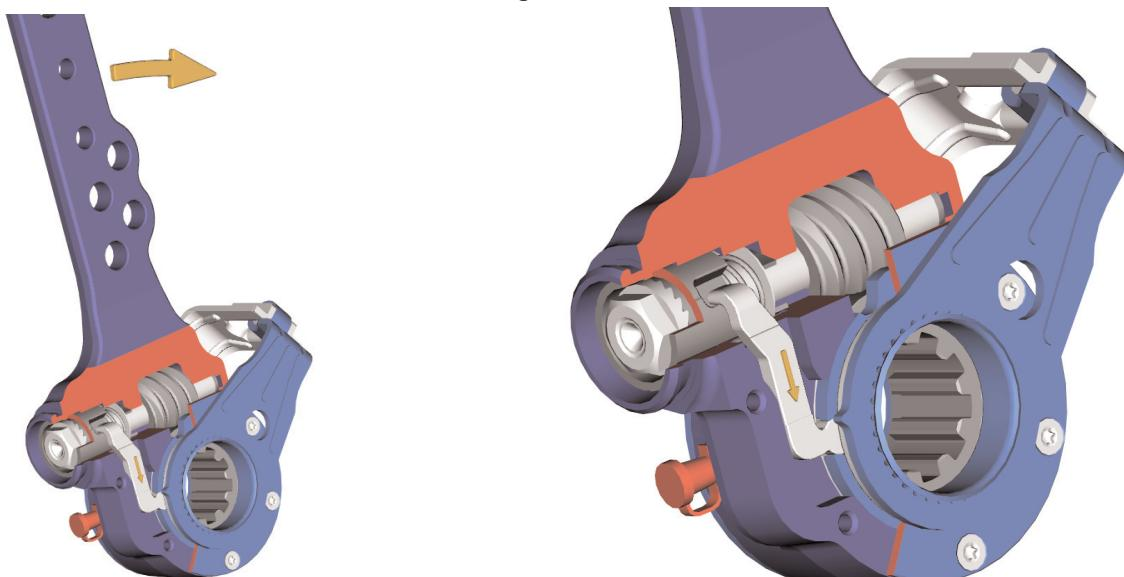
Die Nachstellung erfolgt beim Lösen der Bremse, im letzten Abschnitt des Rückhubes. Der Nachstellhebel bewegt sich zurück und bewirkt, nach Überwinden des Spielraumes innerhalb der Kupplung, eine Zugkraft an der unteren Nutflanke der Kupplungshülse.
