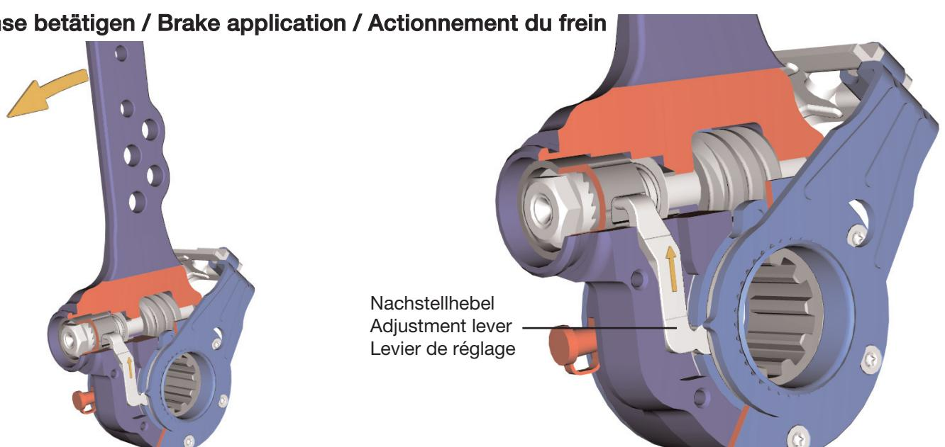
Beim Betätigen des Automatischen Gestängesteller wird das Rückstellmoment der Bremse überwunden. Der Bremsbelag liegt an der Bremstrommel an. Der Nachstellhebel verschiebt sich gegen die obere Nutflanke der Kupplungshülse.
