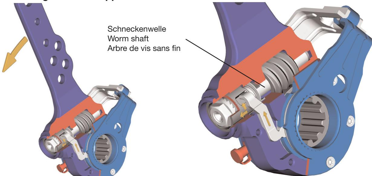
Wird beim Bremsvorgang der Nachstellpunkt erreicht, rasten die Zähne der Kupplungshülse in die nächste Zahnlücke der Schneckenwelle ein.
