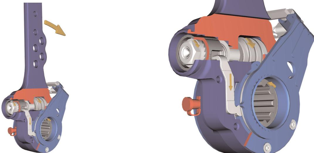
Im Nachstellbereich wird die Kupplungshülse über die eingerasteten Zähne, die Schneckenwelle und damit das Schneckenrad mit Bremsnockenwelle gedreht. Dadurch wird das Lüftspiel zwischen Bremsbelag und Bremstrommel verkleinert. Die Nachstelleinrichtung ist so ausgebildet, dass selbst bei großen Hüben (z.B. bei Wärmeausdehnung der Bremstrommel, Belagverschleiß, Elastizität) immer ein ausreichendes Lüftspiel vorhanden ist.
